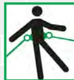
**Anillos cadera:** Para posicionamiento o restricción; estos sistemas permiten al usuario mantenerse suspendido en elevación frente a su área de trabajo, de manera cómoda para trabajar con las manos libres.
