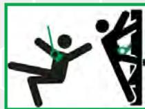
**Anillo en pecho:** Utilizados para ascenso y descenso controlado que permite permanecer suspendido mientras se realiza el trabajo (Tripié, poleas, escaleras marinas, etc.).
