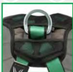
La placa de plástico trasera "Galleta" tiene un conector para el limitador personal de caídas (PFL), liberando el anillo D de la espalda para cualquier otro uso, el diseño en "Y" reduce la carga del cuello ya que dirige las cintas lejos del mismo.
